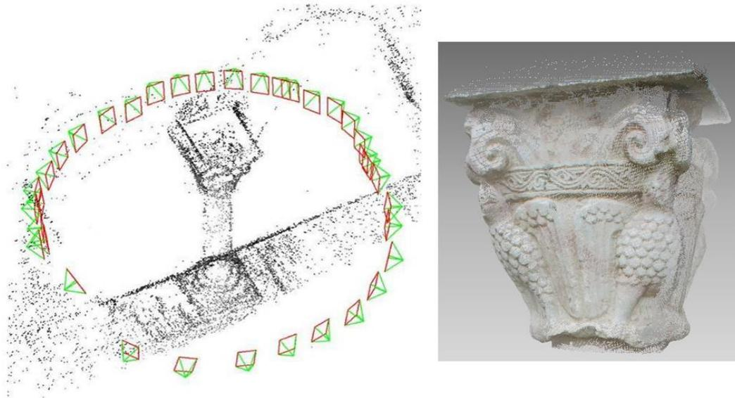
Figure 26 : Génération automatique d'un nuage de points à partir de photographies convergentes d'un chapiteau du cloître de Cuxa (projet « Abad Oliba » © laboratoire MAP (UMR 3495 CNRS/MCC), 2012).
