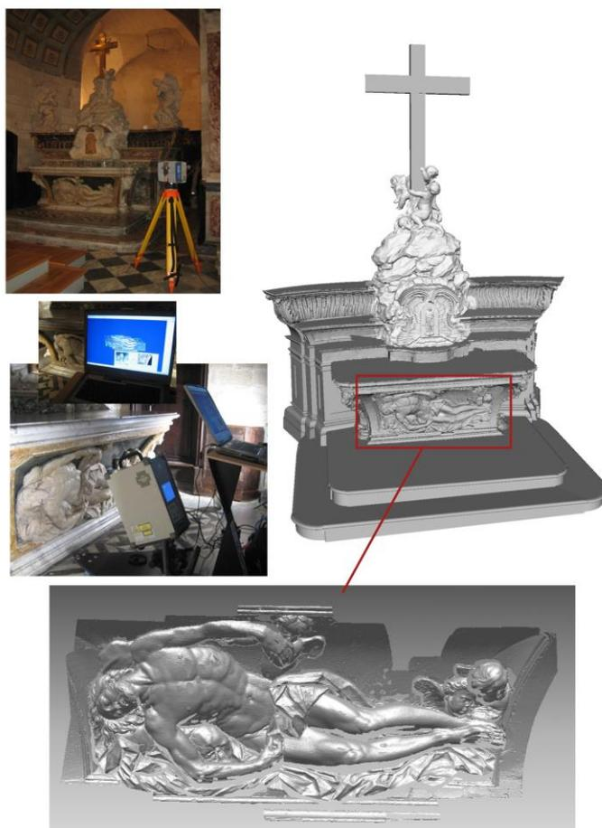
Figure 86 : Relevé lasergrammétrique du maître-autel : un scanner à décalage de phase a enregistré la structure générale, un scanner à triangulation optique a numérisé les éléments sculptés. Modèle 3D final du maître-autel et détail du gisant présentant de nombreux « trous » (© laboratoire MAP (UMR 3495 CNRS/MCC), 2010).
